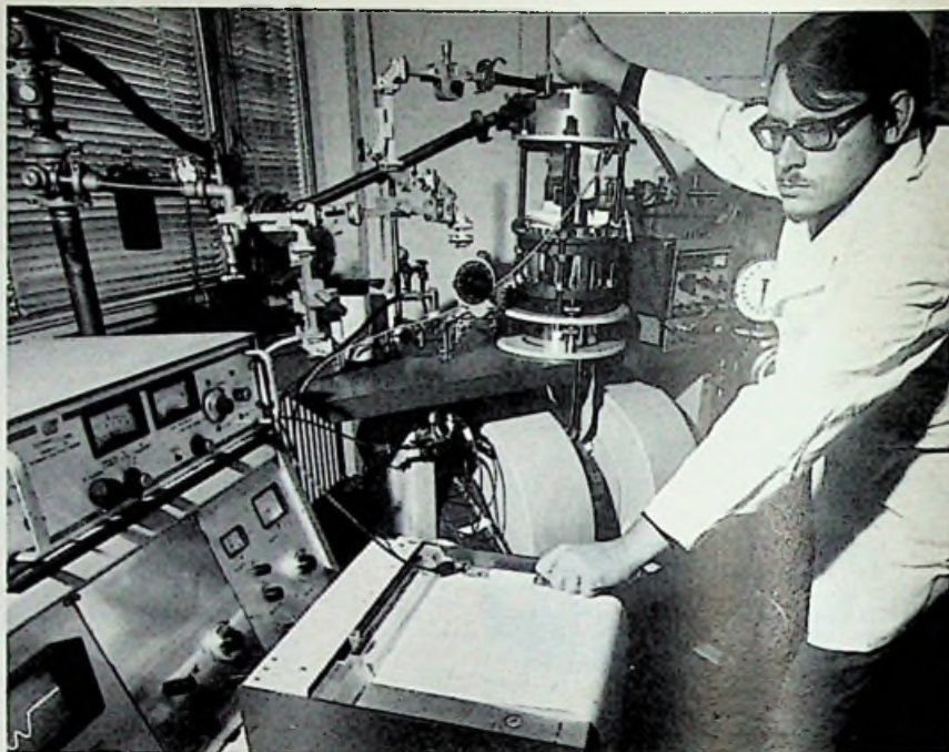
ESR-spectrometer 20XT van AEG-Telefunken bij het aantonen van zuurstofatomen in siliciumkristallen
